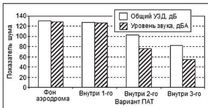
Рис. 2. Характеристика акустической обстановки для создания СКЗ ИТС от шума.
